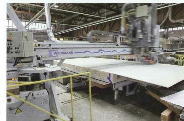
Der Zuschnitt der Beplankung erfolgt maschinell.
