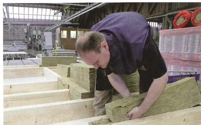
Dämmung wird von Hand eingebracht.
