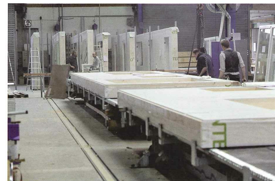
Halbfertige Wandelemente auf den Weg zur Weiterbearbeitung.
